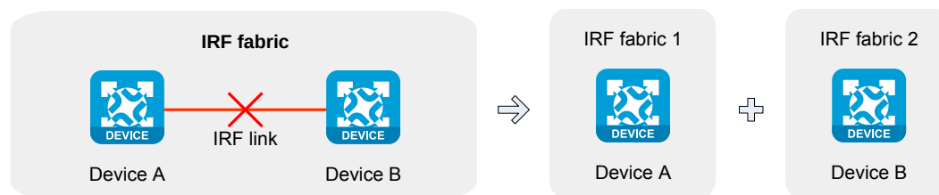
图-3 IRF 分裂示意图
