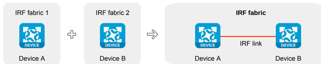
图-2 IRF 合并示意图
