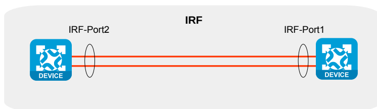
图-4 IRF 物理连接示意图
