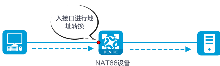
图-1 入接口地址转换示意图
