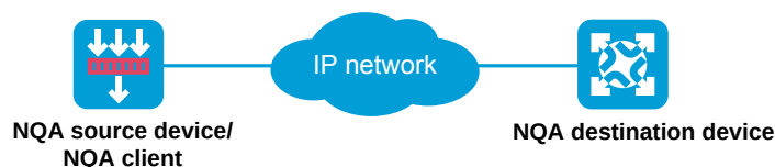
图-22 NQA 测试典型组网图
