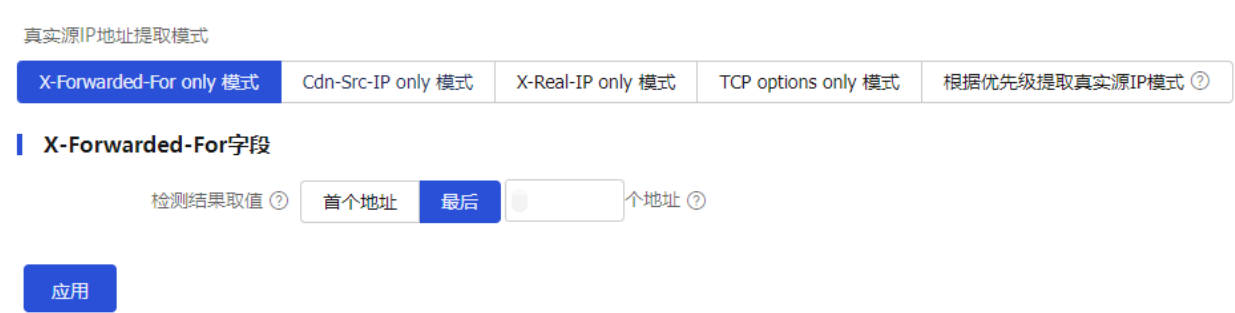
图-6 真实源 IP 地址提取模式
